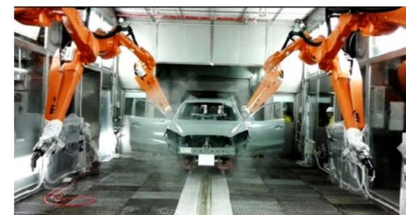
Aqua-tech 是立邦涂料研发的紧凑型绿色环保涂装技术，是目前全球涂装线长度最短的工艺。Aqua-tech 和其它水性涂装工艺（3C1B、3C2B、IPP、Eco-concept）相比，融合了低耗环保、实现客户个性化需求、生产线便捷转换三大优势，有效地降低涂装过程中的尘埃对漆膜外观的影响，缩短生产线，减少涂装机械设备及 VOC 排放。
